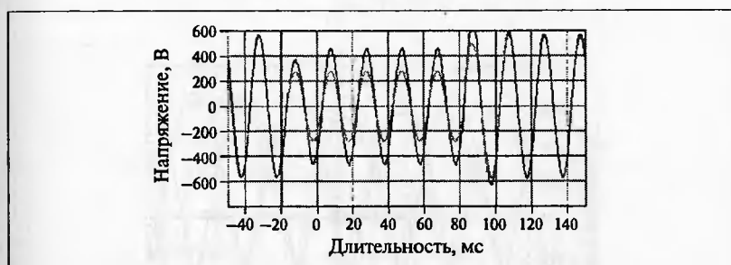
Рис. 3.16. Реакция ДКИН на междуфазный провал напряжения глубиной 50 % номинального и длительностью 100 мс
