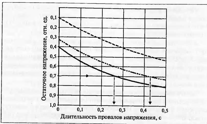
Рис. 3.23. Характеристики работы ДКИН при одно-, двух- и трехфазных провалах напряжения различной длительности
