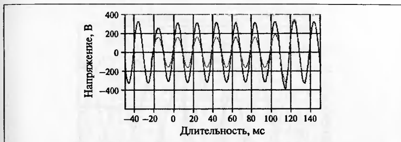
Рис. 3.15. Реакция ДКИН на однофазный провал напряжения глубиной 50 % номинального и длительностью 130 мс
