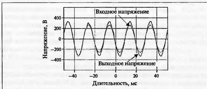
Рис. 3.11. Реакция ДКИН на остаточное напряжение, равное 80 % номинального
