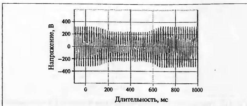
Рис. 3.14. Реакция ДКИН на провал напряжения глубиной 50 % номинального и длительностью 1 с
